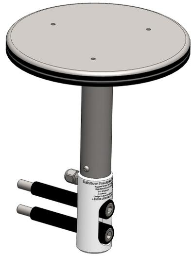
HDI는 저전력 장치입니다. 움직이는 부품이 없어 유지보수가 거의 필요 없는 완전 밀봉형이며 기계적으로 매우 튼튼한 음향 분석 기술 응용기기입니다. 지름 0.5cm에서 7.5cm 사이의 우박을 감지할 수 있으며, 극한의 환경(우박 사건)에서 적용 가능합니다. 계측기의 감지 부분은 매우 튼튼한 스테인리스강 팔에 의해 지지되는 3층 폴리싱 스테인리스 원판입니다. 우박(또는 같은 운동 에너지의 범위에 있는 다른 암석계)의 충격은 내부 음압의 측정 가능한 변화를 유도합니다.
